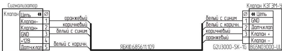
Рисунок Б.6 – Схема подключения клапана КЗГЭМ-У с разъемом BG5NO3000-UL.
